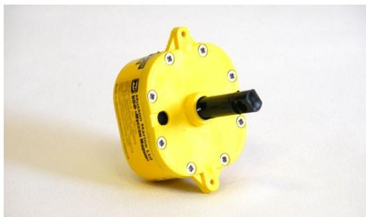
**Гидростат G-5** является автоматическим разобщающим устройством для использования со спасательными плотами, буями (EPIRB) и другим оборудованием. G-5 не требует сервисного обслуживания и подлежит замене через каждые 2 года. Гидростат G-5 активируется увеличением давления воды при погружении. Устройство крепится к радиобую специально разработанным пластиковым болтом вместо канатной стропы.
