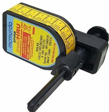
**Гидростат MCM 82-962-001A** для аварийного радиобуя **MCMURDO** — является разобщающим устройством. Принцип действия заключается в отделении аварийного буя от судна во время чрезвычайной ситуации. Активируется на глубине 2-4 метра.
