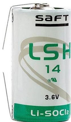
**Батарейка LSH-14** – представляет собой разовый элемент питания с литий-тионилхлоридным химическим составом Li-SOCl<sub>2</sub> и номинальным рабочим напряжением 3,6 В и ёмкостью 5800мАч. Изделие имеет энергетически оптимизированные электроды рулонной конструкции. Батарейка состоит из: корпуса, метало-стеклянного гермовывода, литиевого анода, жидкого катода, угольного катализатора и предохранительного клапана.
